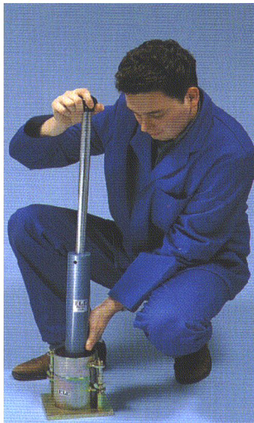
Figura 2.5. Forma de ejecutar la compactación y equipo necesario. Fuente: ELE Internacional Ltda., 1993.
