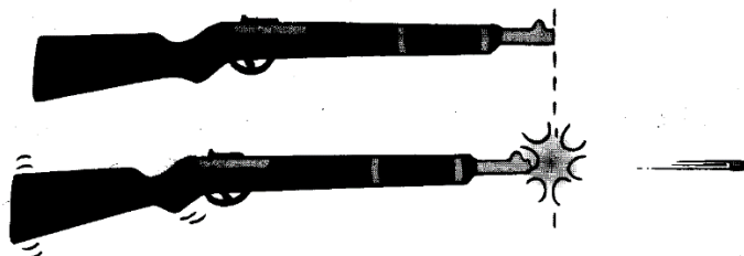
Fig. N°6.1 Se muestra el disparo de un rifle, aplicación de la ecuación de cantidad de movimiento.
