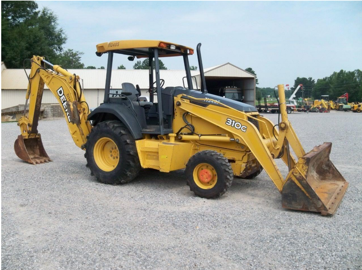
Retroexcavadora Jonh Deere 310g
