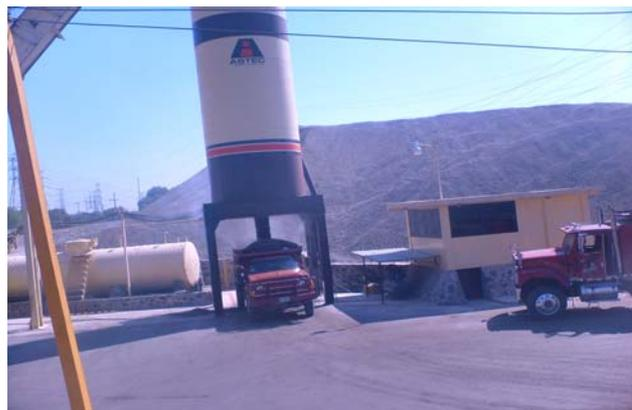
**Fig. 1.3.10 Vaciado del concreto asfáltico a las unidades de acarreo. La mezcla sale a una temperatura de 140°C.**
