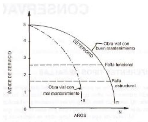
**Fig. 4.1.1** Esquema que muestra el deterioro en las obras viales a través del tiempo y los efectos de una conservación buena y otra deficiente.
