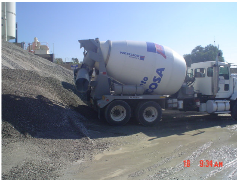
Fig. 10-10. El concreto premezclado normalmente se lo puede colocar en su localización final a través de la descarga directa por el canalón desde el camión mezclador.
