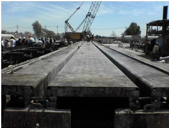
Figura 5.6 Molde y mesa de colado de concreto presforzado para traveses doble T
