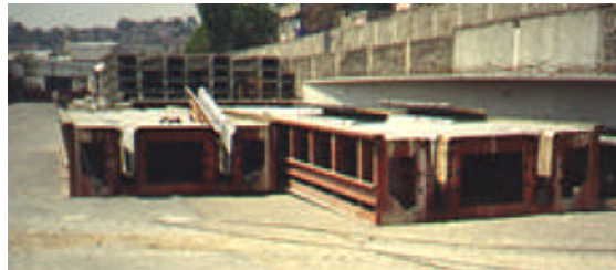
Molde autotensable de acero (trabe doble T)
