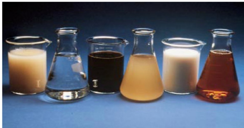
Aditivos líquidos, de la izquierda hacia la derecha: aditivo antideslave, reductor de retracción, reductor de agua, agente espumante, inhibidor de corrosión e incorporación de agua.
