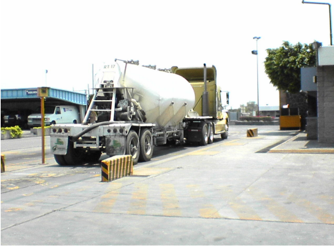
Figura 5.9 Detalle de almacenaje y transporte de cemento a granel en una planta de producción.
