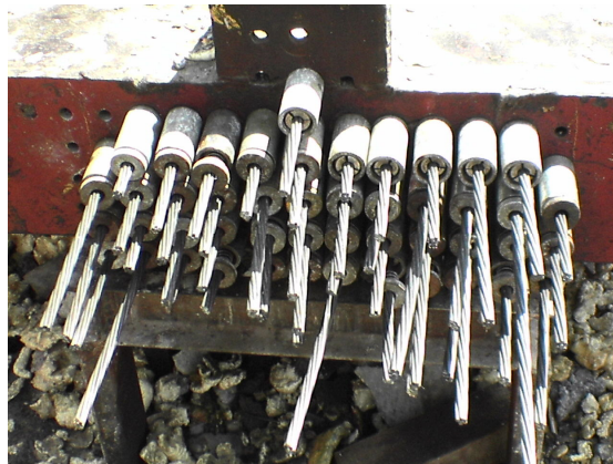
Figura 5.7 Molde autotensable de acero (trabe doble T)
