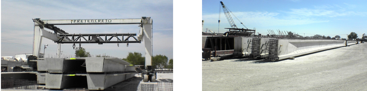
Figura 5.12 Apoyos en almacenaje de traves T.
